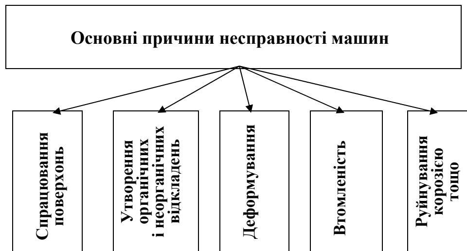
**Спрацювання** – це зміна маси, розмірів і форми деталей під впливом механічних та фізико-хімічних процесів, що відбуваються на робочих поверхнях деталей. Наприклад, циліндрична поверхня внаслідок спрацювання стає овальною, конусною або бочкоподібною і маса її зменшується на величину втраченого металу.
