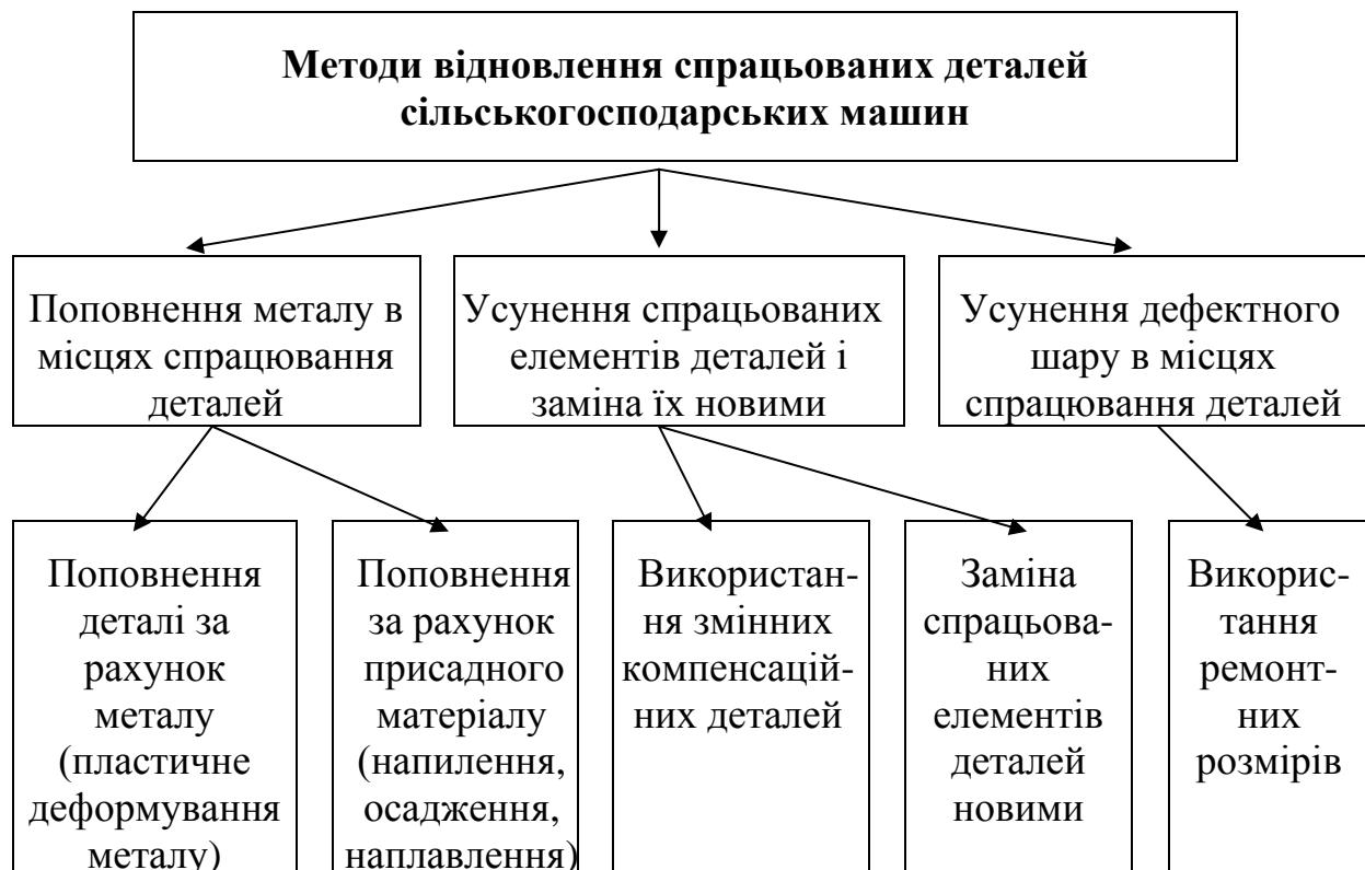
До найбільш поширеніх методів відновлення спрацьованих деталей відносять наплавлення за допомогою електричного струму, гальванічні покриття, електроерозійне нарощування, металізацію, перезаливання антифрикційного сплаву, паяння, пластичне деформування.
